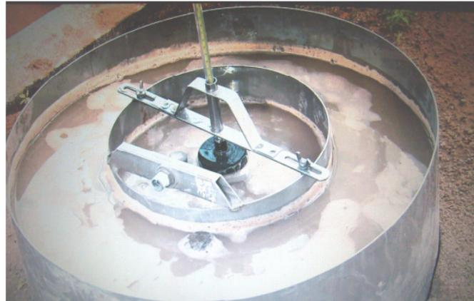
Figura 15. Infiltrómetro de Doble Anillo. Fuente: ©UDSuelos-Universitat Politècnica de València (2010).
