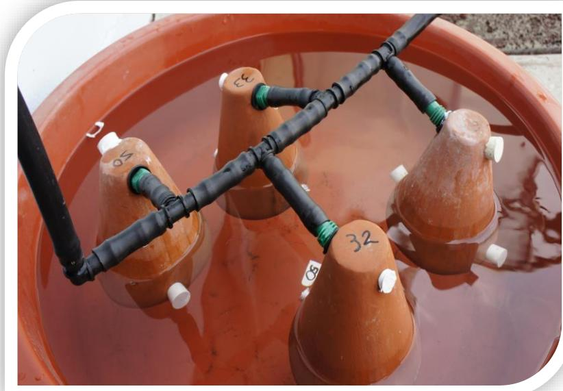
Se propuso utilizar conectores comerciales de riego para hacer las interconexiones entre las capsulas para mejorar el funcionamiento del sistema
