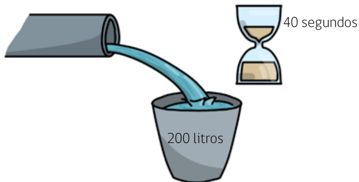
FIGURA 25. Método volumétrico para estimar caudal.
