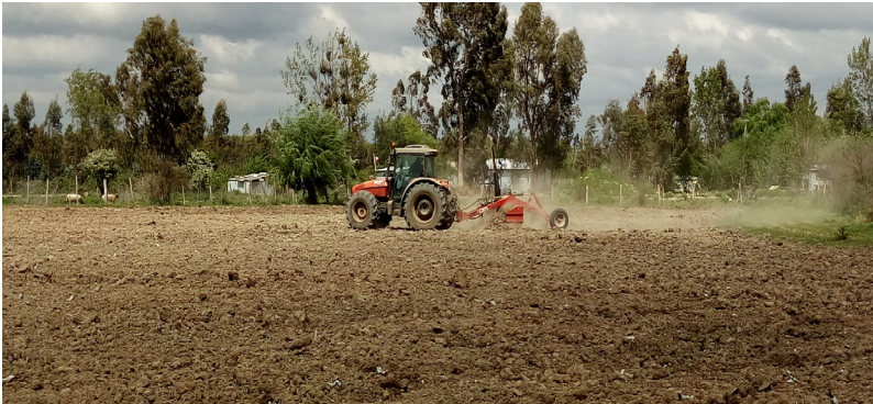
Figura 27. Maquinaria utilizada para nivelar o emparejar terrenos.
