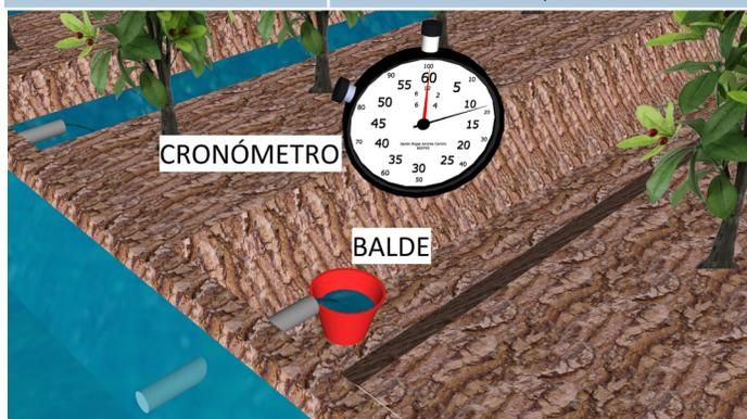
Figura 4. Medición de caudal en riego por surcos.
